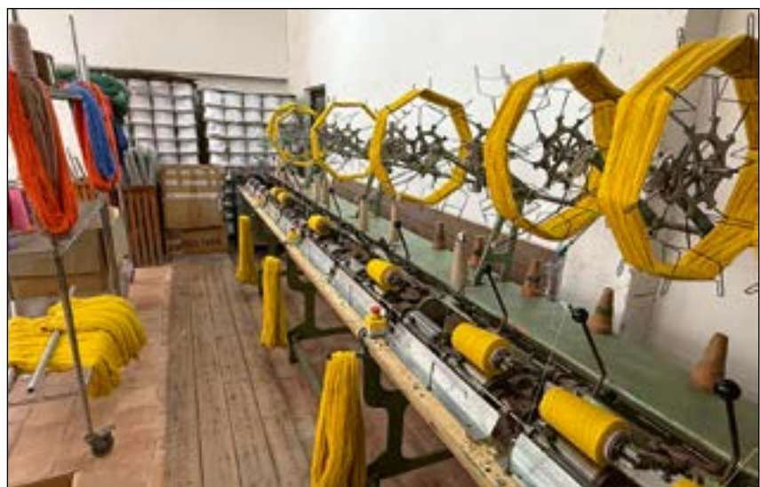
Das Garn wird an einer historischen Spulmaschine verarbeitet. Die Fäden werden über die sternförmigen Haspeln geführt und anschließend auf großen Spulen aufgewickelt
