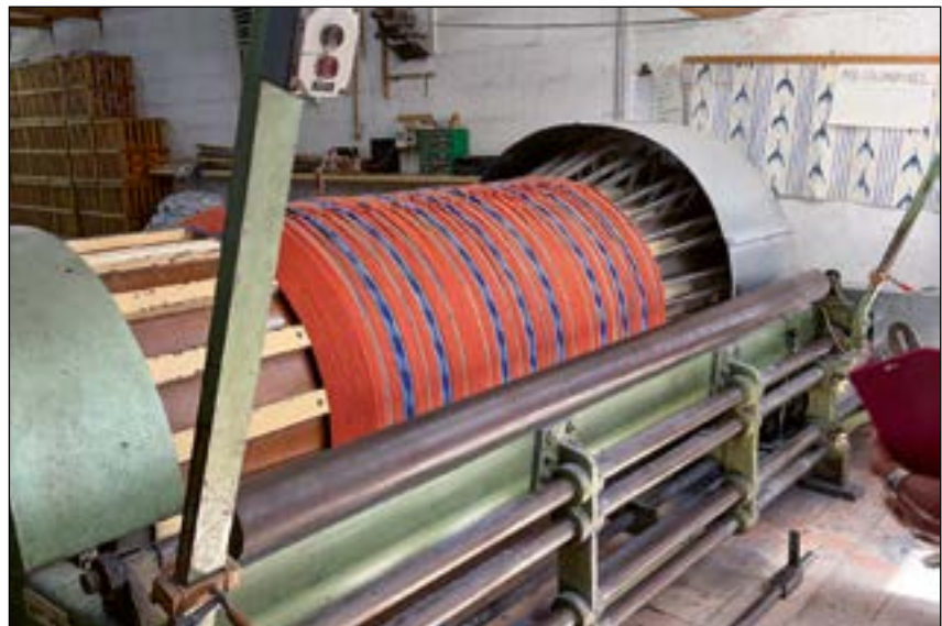
Auf dieser Rolle, dem Uridor, werden die Fäden in der richtigen Abfolge angeordnet
